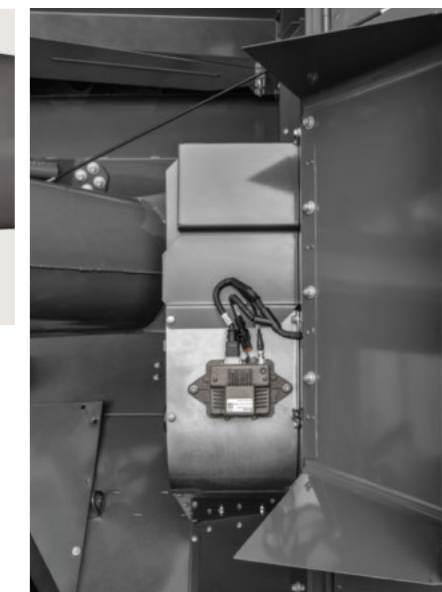
Livedata fra marken sikrer, at du altid har et godt overblik over udbytte, fugtighed og kvalitet: Sensorer for udbytte og fugtighed samt et kerne kvalitetskamera er monteret på elevatoren. Dataene er 98 % nøjagtige og udnyttes ved hjælp af VarioDoc ISOBUS standarden, live-kortlægning af udbytte og IDEALharvest™.
