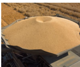
17.100 l kapacitet i Streamer 210 tømmes på ca. 81 sekunder.
