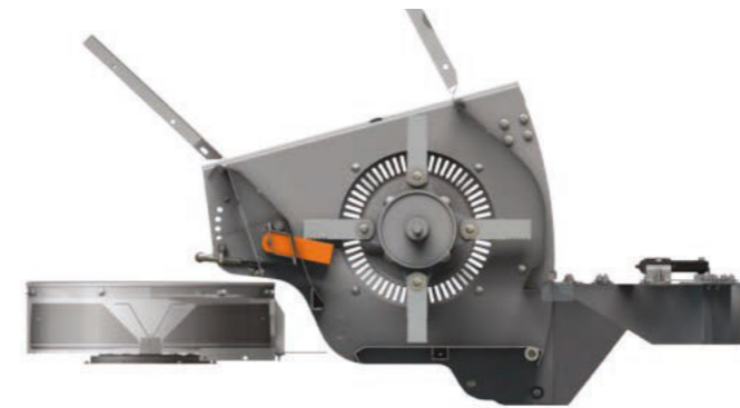
BaseCut halmsnitneren fungerer som standard i Fendt IDEAL med 56 knive.
