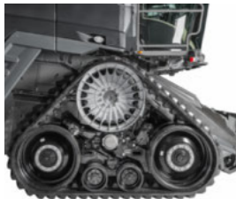
TrakRide bæltene sikrer et usædvanligt lavt marktryk.
